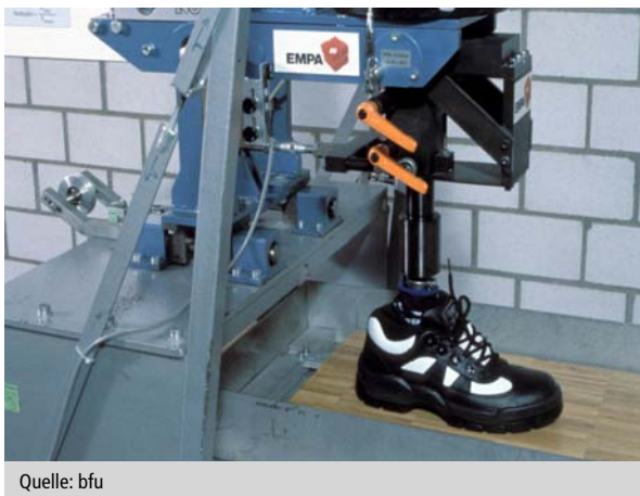
Abbildung 1 Boden- und Schuhtester BST 2000, EMPA St. Gallen
